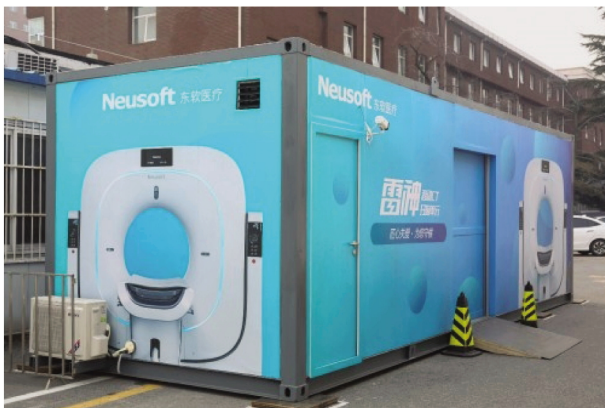
图 1 东软雷神方舱 CT。方舱 CT 外观为分体式箱体设计(A 图),内部为隔室操作,并配有监控系统及影像检查工作站(B 图)。
