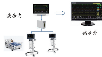
图7 呼吸机监控系统拓扑图
